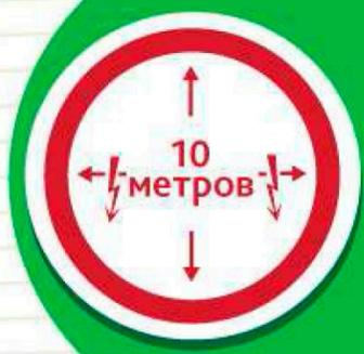
В радиусе 10 метров от лежащего на земле оборванного провода опасная зона - земля на этом участке находится под высоким напряжением!
